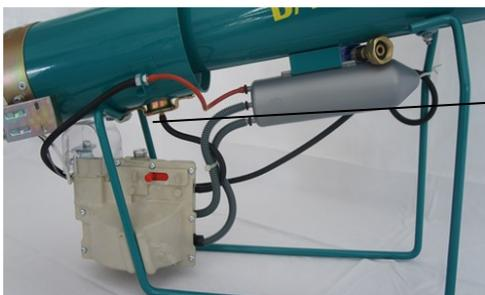
Débrancher le tuyau en silicone, brancher le tuyau court de l'horloge sur le réservoir cf schéma ci-dessous
